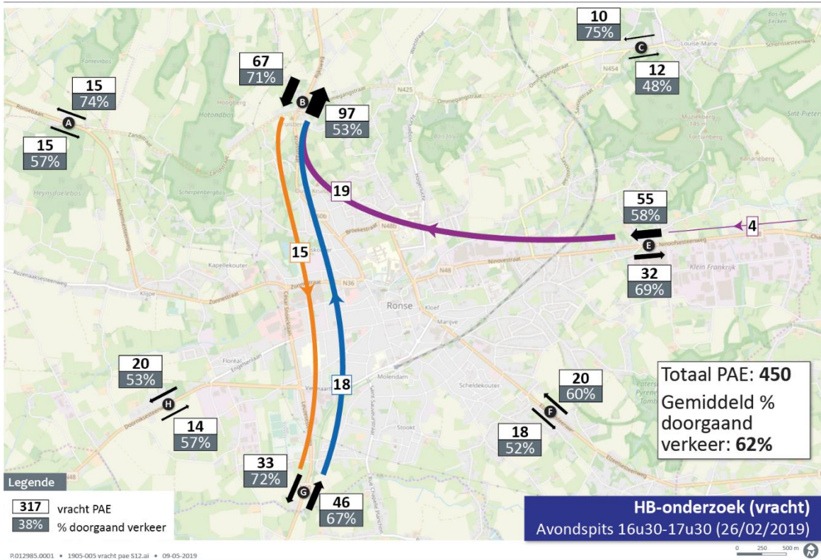
Figuur 29 Herkomst-Bestemmingsonderzoek invalswegen: vrachtverkeer ASP (16u30-17u30) Alle doorgaande vracht-relaties >10 PAE worden afgebeeld.
