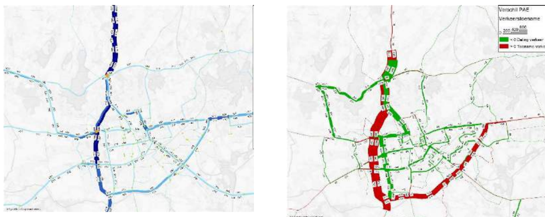
Figure 5.18 | Intensités du trafic (à gauche) et graphique des différences (à droite) pour l'heure de pointe du matin (alternative G3)
