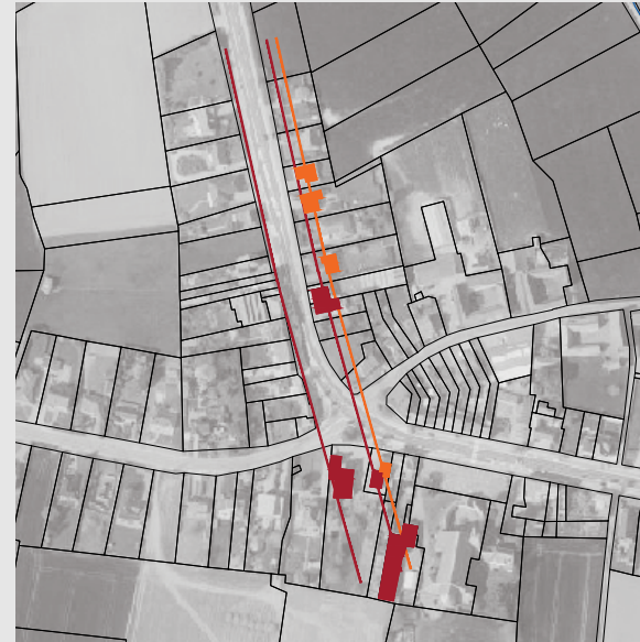
Inname van gebouwen en percelen tijdens constructie centrale tunnel met enkele of dubbele koker onder de N36/Zonnestraat.
